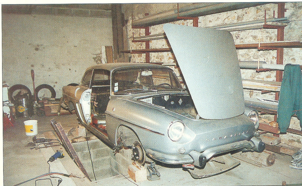
Travail sur les bas de caisse et les longerons, au-dessus de la fosse.
