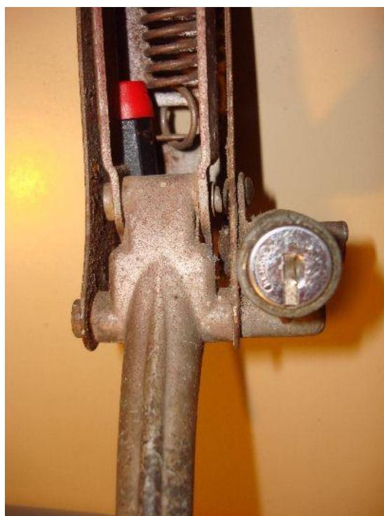
La fixation est assurée par une goupille conique notée 1 et un oeillet en laiton noté 2
