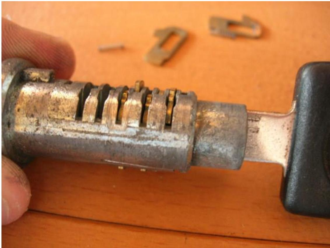
Alors, toujours avec la clé dedans on arase soigneusement à la lime les paillettes en laiton qui dépassaient du barillet.
